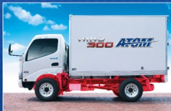
ระบบช่วงล่างออกแบบใหม่ รองรับน้ำหนักบรรทุกเต็มพิกัด (ระยะกึ่งกลางล้อหน้า/หลัง กว้าง 1.56/1.62 เมตร)
